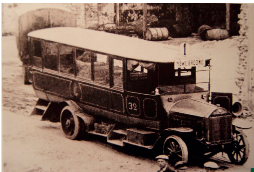
Jeden z autobusów Benz - Gaggenau, które w sierpniu 1920 r. przewoziły żołnierzy na przedpola Warszawy. Za autobusem przyczepka, także marki Benz.
